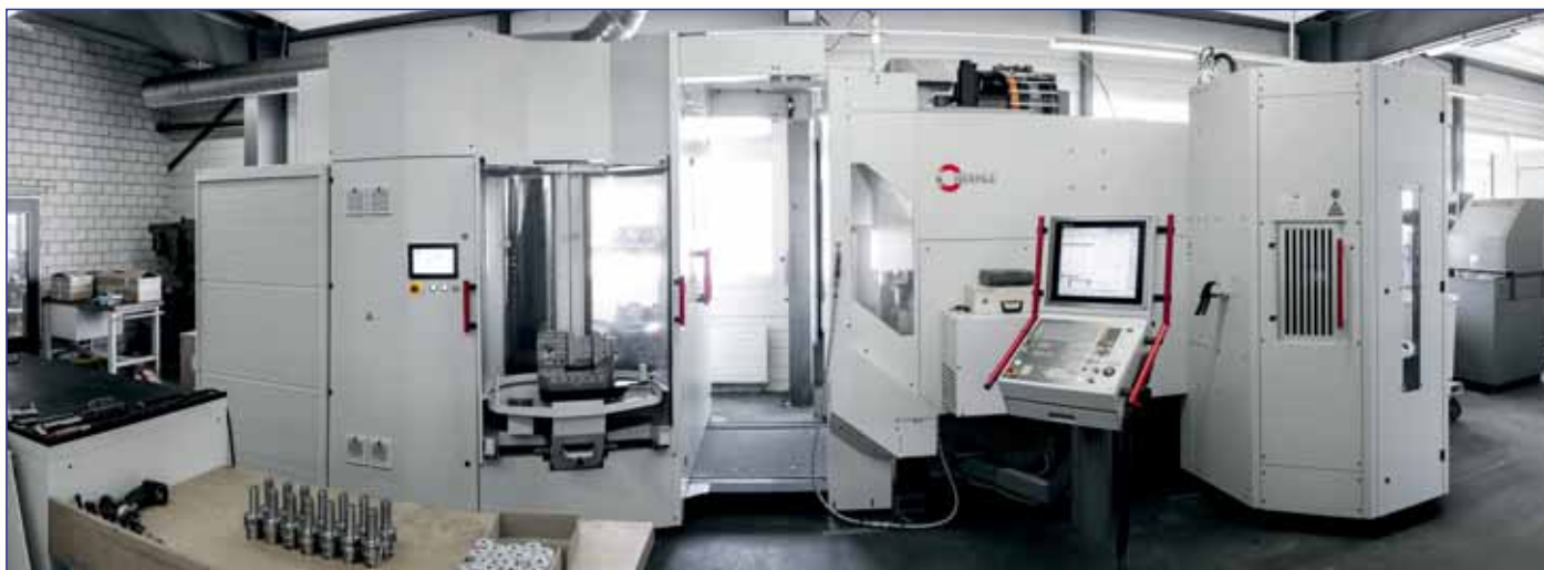
5-осевой обрабатывающий центр C 22 U с расположенным слева устройством смены палет PW 150 (система содержит общим числом 11 сменных палет 320 x 320 и/или 400 x 320 мм), спереди слева находится станция оснастки палет
