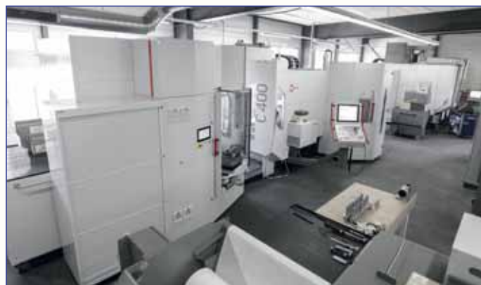
"Бульвар Hermle" на фирме Feusi AG с 5-осевым обрабатывающим центром C 400 U, оснащенный магазином заготовок, 5-осевым обрабатывающим центром C 22 U с устройством смены палет PW 150 и 5-осевым обрабатывающим центром C 42 U/MT с функцией вращения
