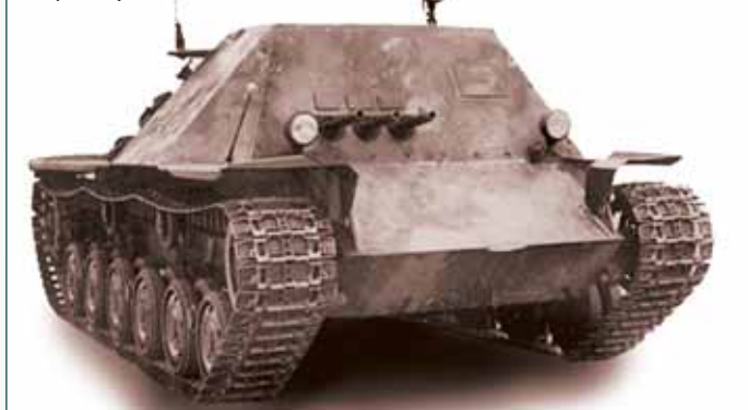
Первый прототип Tankett fm/49 в версии пулеметной самоходки
