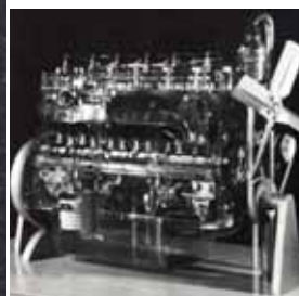
Прозрачная модель двигателя "Wanderer W-23" в Атласе [2]
