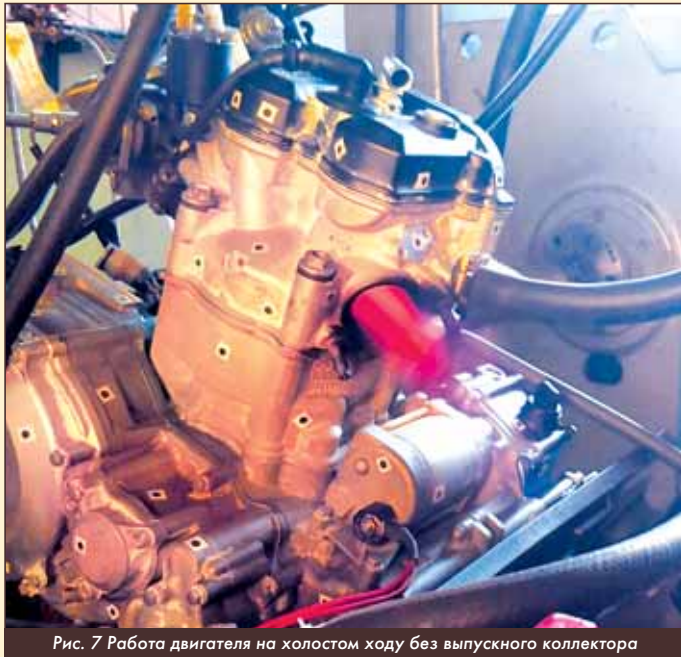
Рис. 7 Работа двигателя на холостом ходу без выпускного коллектора
