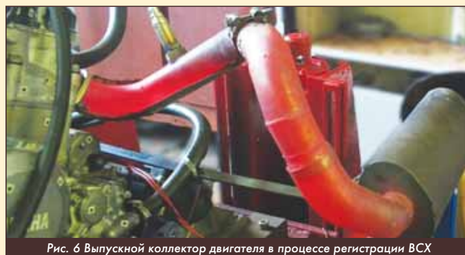
Рис. 6 Выпускной коллектор двигателя в процессе регистрации ВСХ
