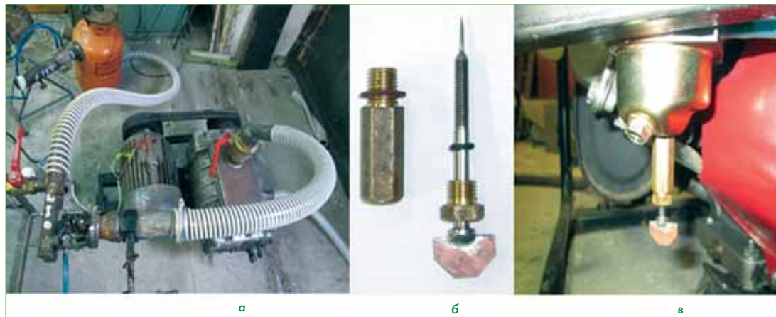
Рис. 2. Общий вид лабораторной установки для моделирования режимов работы системы питания ДВС (а), система регулирования подачи бензина: жиклёр с изменяемым сечением (б) и карбюратор с установленным модернизированным жиклёр (в)
