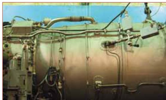
Рис. 4 Монтаж измерительного модуля СДР на двигателе
