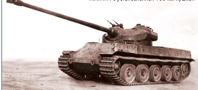
AMX M4 с установленной 100-мм пушкой
