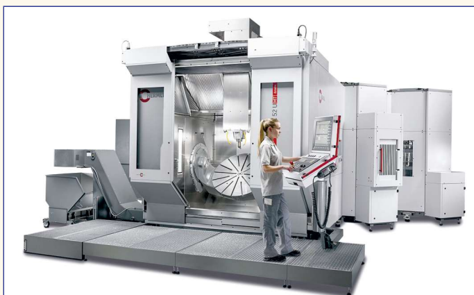
5-осевой обрабатывающий центр С 52 U MT dynamic в модификации Mill/Turn с дополнительным инструментальным магазином
