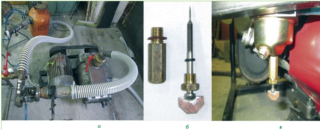
Рис. 2. Общий вид лабораторной установки для моделирования режимов работы системы питания ДВС (а), система регулирования подачи бензина: жиклёр с изменяемым сечением (б) и карбюратор с установленным модернизированным жиклёром (в)
