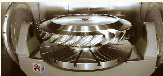
5-осевая токарная и фрезерная обработка колеса с одним зажимом
