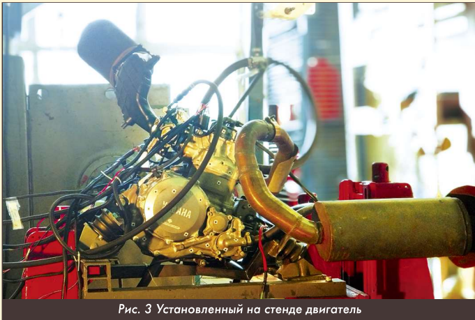
Рис. 3 Установленный на стенде двигатель
