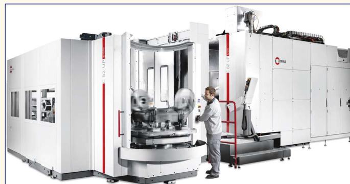
Устройство смены палет PW 3000 на 5-осевом обрабатывающем центре Hermle
