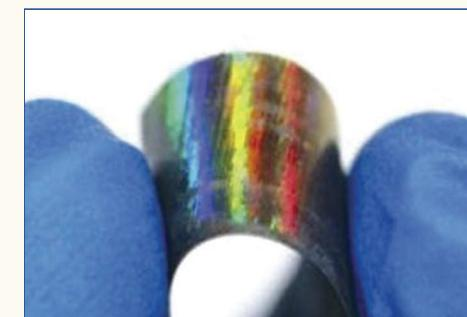
Другой интересный потенциал данной технологии заключается в том, что пустое пространство в металлической структуре может быть заполнено другим материалом. Естественно, что металлическая структура, заполненная жидким или твердым электролитом, может стать элементом аккумуляторной батареи очень большой емкости, которая сможет питать очень долгое время устройство, в которое она встроена.
