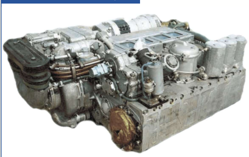
5-ТД с оппозитным движением поршней
