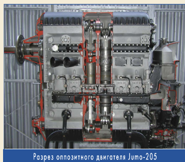
Разрез оппозитного двигателя Jumo-205
