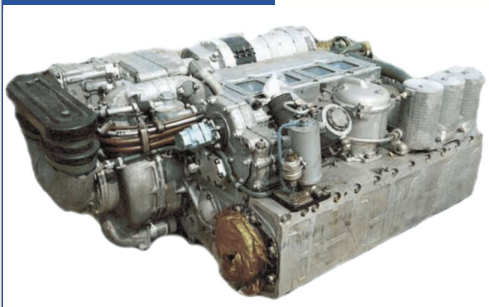
5-ТД с оппозитным движением поршней
