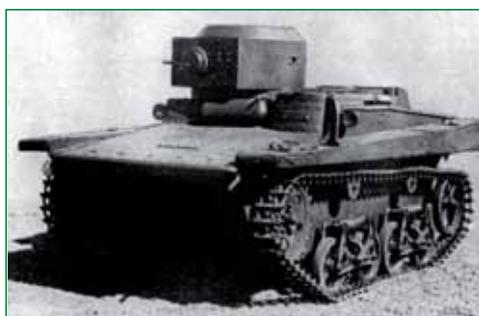
Рис. 5 Разведывательный танк Т-37А плавающего типа
