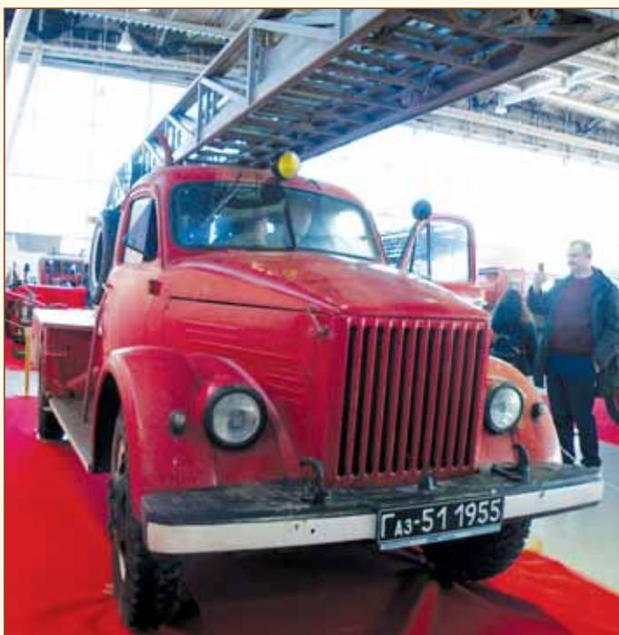
В 1958 году изготовлена модель ЛЧ с ручным приводом механизмов. Серийно не выпускалась в связи с техническими недостатками конструкции и трудоёмкостью ручных операций по выдвижению и повороту лестницы.
