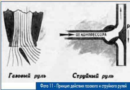
Фото 11 - Принцип действия газового и струйного рулей
