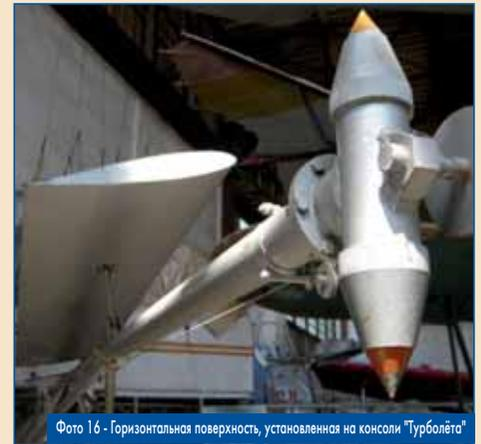
Фото 16 - Горизонтальная поверхность, установленная на консоли "Турболёта"
