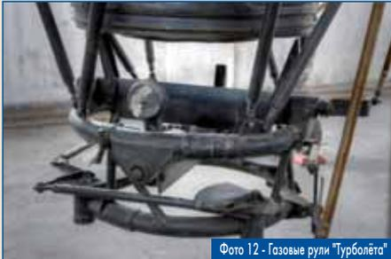
Фото 12 - Газовые рули "Турболёта"
