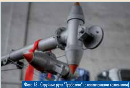
Фото 13 - Струйные рули "Турболёта" (с навинченными колпачками)
