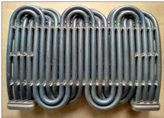
Рис. 1 Двухрядный, четырёх трубчатый, пяти поворотный и шести перекрёстный ВВТ, с наружным диаметром трубок 6,0 мм
