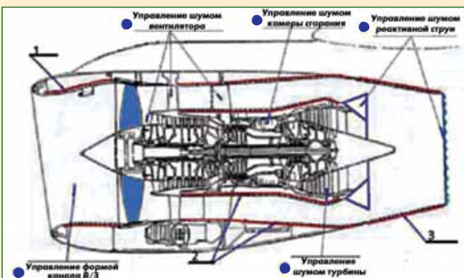
Рис.1 Основные направления по повышению акустической эффективности системы шумоглушения силовой установки для перспективного самолета
