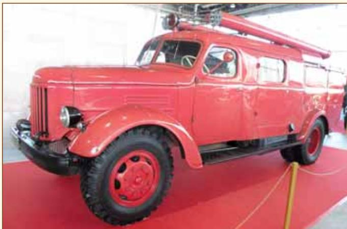
жар напорных рукавов: 16 рукавов диаметром 51 мм и 33 рукава диаметром 66 мм. Надёжность конструкции автонасоса ПМЗ-18 пользовалась уважением у водителей. По мере поступления новой пожарной техники старые автонасосы из городов передавались на вооружение добровольных пожарных дружин в сельские районы.
