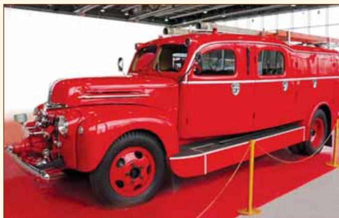
Пожарный автомобиль в типично американском стиле с расположением насоса впереди, а не сзади, как это принято, например, у европейских или советских пожарных машин. Такая необычная компоновка не только освобождала место за кабиной, но и делала более удобной работу пожарных с насосом, вокруг которого было намного больше свободного пространства, чем если бы он устанавливался сзади.
