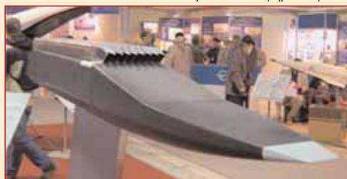
**Рис. 1** Гиперзвуковой прямооточный воздушно-реактивный двигатель летящей лаборатории ГЛЛ-АП (макет) на МАКС-2009
