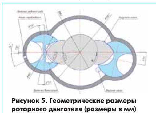
**Рисунок 5. Геометрические размеры роторного двигателя (размеры в мм)**
