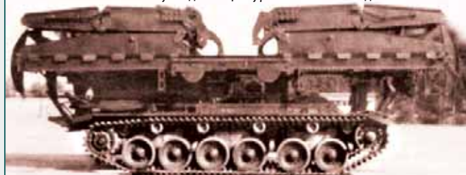
Мостоукладчик "Центурион" ARK в походном положении
