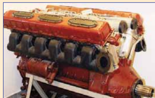
Танковый дизель В-2 конструктора А.Д. Чаромского. Рабочий объём 61,07л.
