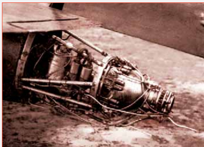
Жидкостный ракетный двигатель РД-1ХЗ на самолете Ла-7Р
