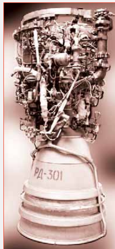
Двигатель РД-301, работающий на жидком фторе и аммиаке
