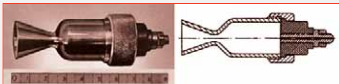
Электротермический ракетный двигатель, разработанный В.П. Глушко в ГДЛ
