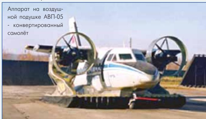
Аппарат на воздушной подушке АВП-05 - конвертированный самолёт
