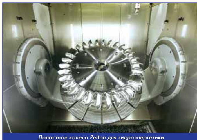
Лопастное колесо Pelton для гидроэнергетики
