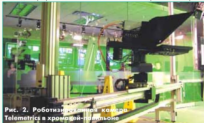
Рис. 2. Роботизированная камера Telemetrics в хромакей-павильоне
