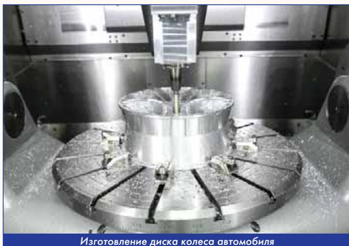
Изготовление диска колеса автомобиля
