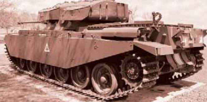
Нерешенной проблемой для разработчиков "Центуриона" оставался малый запас хода. На пятой модели его попытались увеличить за счет установки в кормовой части корпуса внешних топливных баков, но по ряду причин более удачным посчитали использование одноколесных буксируемых бронированных прицепов-баков на 900 л. Масса прицепа без горючего составляла 1,3 т.
