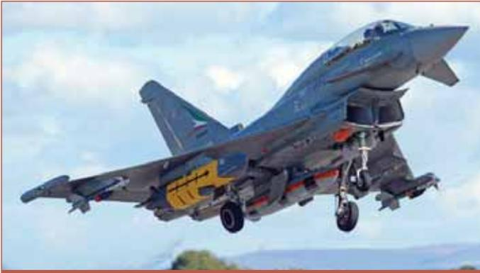
Рис. 3 Ракета "Сторм Шэдоу" под крылом истребителя "Тайфун"
