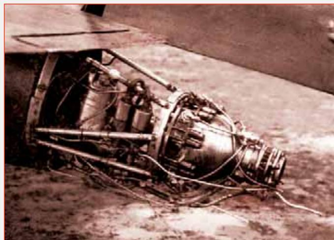
Жидкостный ракетный двигатель РД-1ХЗ на самолете Ла-7Р
