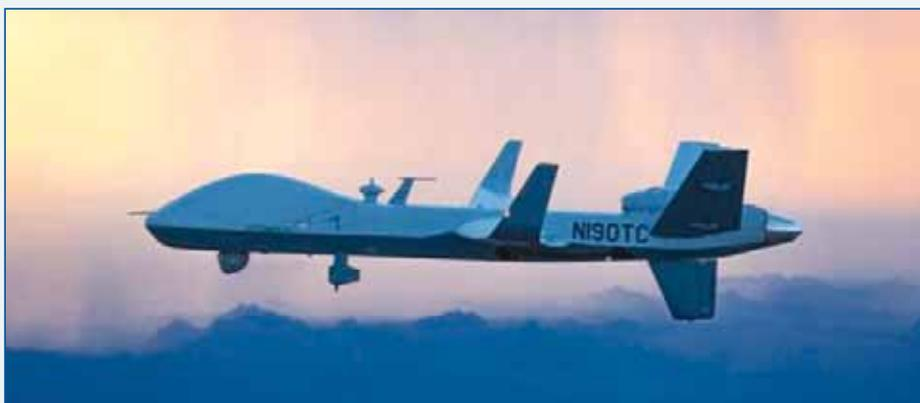
Беспилотник SkyGuardian MQ-9B имеет размах крыльев 24 метра и приводится в движение турбовинтовым двигателем Honeywell TPE331-10. Он может поднимать в воздух груз, массой до 2155 килограмм, и имеет максимальную скорость в 210 узлов (389 километров в час). Беспилотник может находиться в воздухе непрерывно в течение 40 часов, находясь при этом на высоте до 12 200 метров.
