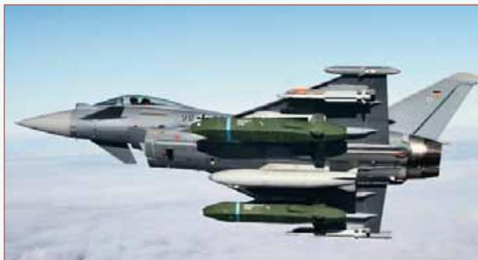
Рис. 1 Ракеты TAURUS KEPD 350 на тактическом истребителе "Тайфун"
