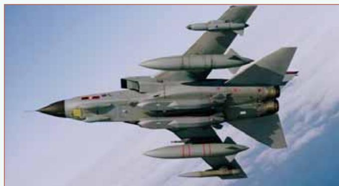
Рис. 2 Истребитель "Торнадо IDS" с ракетами "Сторм Шэдоу" под фюзеляжем
