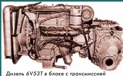
Дизель 6V53T в блоке с трансмиссией
