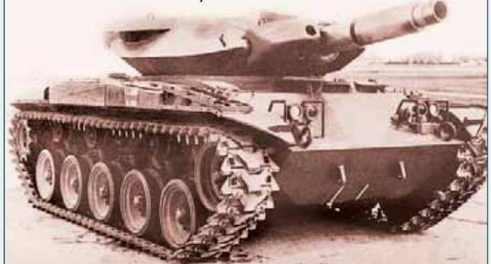
Опытная башня танка XM551 установлена на танк М41
