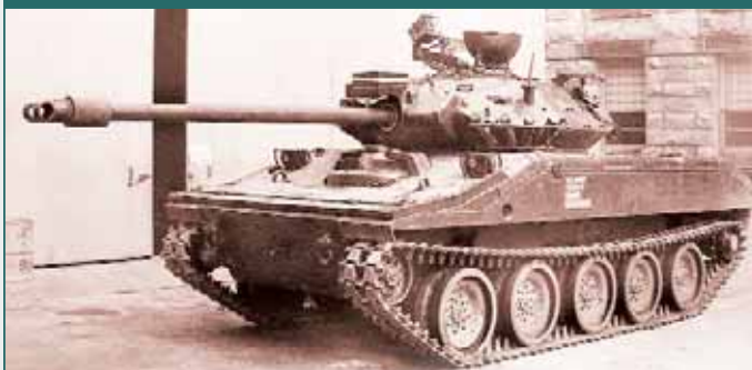
Экспериментальный "Шеридан" с 76-мм пушкой
