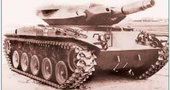
Опытная башня танка ХМ551 установлена на танк М41
