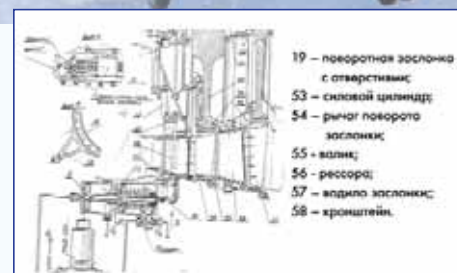
Рис. 3 Система регулирования подачи охлаждающего воздуха на двигателе Р-28В-300
