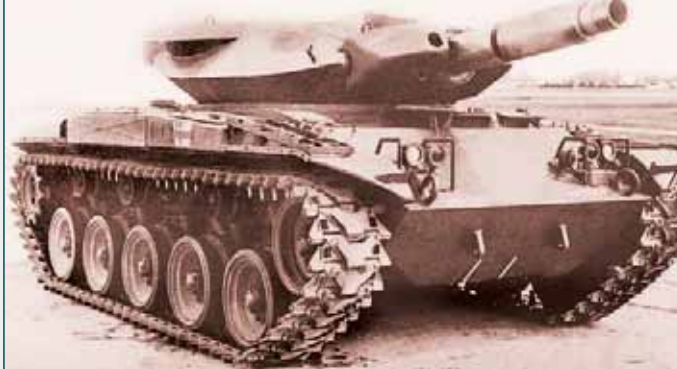
Опытная башня танка XM551 установлена на танк M41
