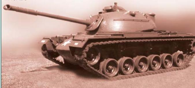
На этом серийные модификации танка М48 заканчиваются, все остальные были получены путём модернизации ранее выпущенных боевых машин. Первой в 1967 году появилась модификация М48А3, для которой брались танки модификаций М48А1 и М48А2. На них устанавливались дизельный двигатель AVDS-1790-2А и трансмиссия Allison CD-850-6 (как на танке М60), а также новая командирская башенка. Запас хода составил 463 км. Всего модернизировали 1019 танков.
