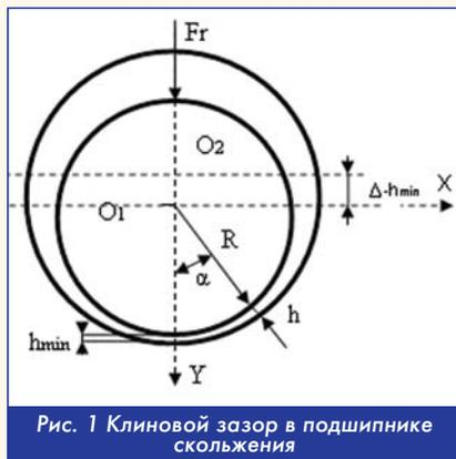
Гидродинамическое давление при полном заполнении зазора маслом и движении потока масла по часовой стрелке формируется в двух четвертях щелевого зазора. В квадранте сужения зазора ( $-\pi/2 < \alpha < 0$ ) от оси X и до оси Y и в квадранте расширения зазора ( $0 < \alpha < \pi/2$ ) от оси Y до X (рис. 1).
