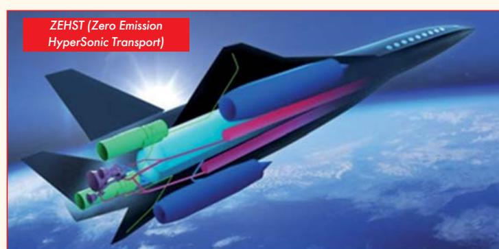
ракетные двигатели обеспечивают набор высоты до 23 км и увеличение скорости до 2.5 Маха. На третьем, крейсерском, этапе тяга обеспечивается за счет прямоточных воздушно-реактивных двигателей для достижения скорости 4 Маха и высоты около 32 км. При снижении и посадке турбореактивные двигатели будут включены еще раз [11].
