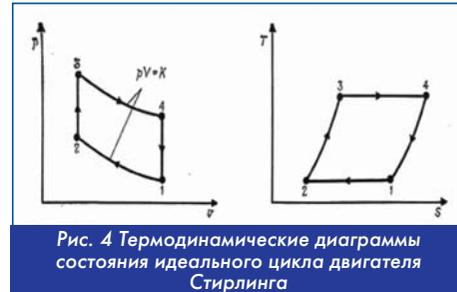
Рис. 4 Термодинамические диаграммы состояния идеального цикла двигателя Стирлинга
