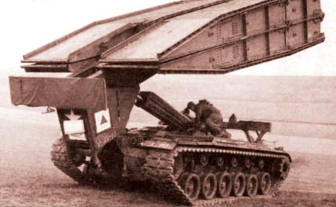
машину приняли в 1958 году. В качестве базы использовались шасси танков М48, М48А1 и М48А2. В конце 1960-х годов бензиновые моторы на мостоукладчиках заменили дизельными.
