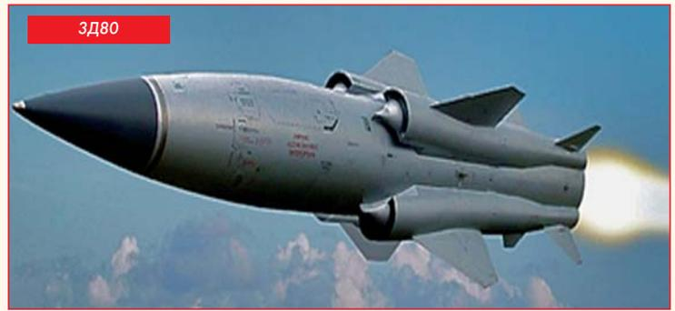
тоту конструкции и отсутствие подвижных элементов, таких как компрессор и турбина, то применение сверхзвуковых прямоточных двигателей оправдано вдвойне.
