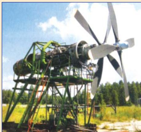
**Двигатель НК-62 на испытательном стенде**
