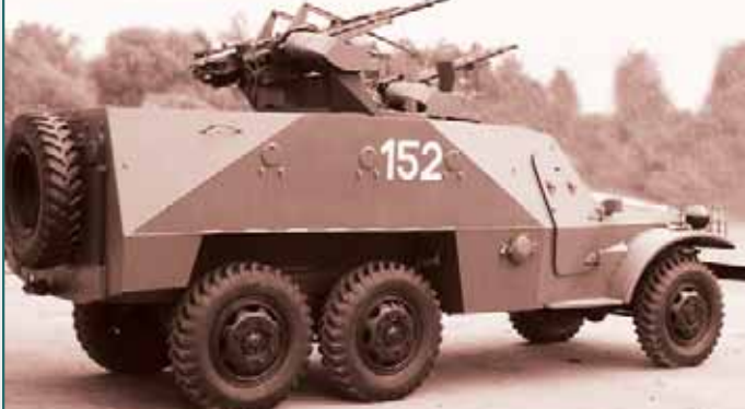
Опытная ЗПУ-4 на базе БТР-152
