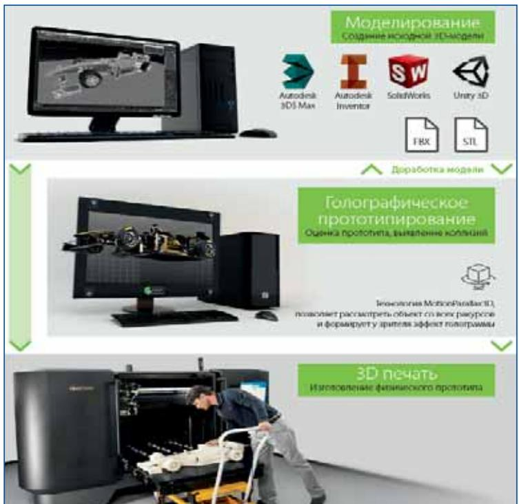
**Рис. 1** Технологическая цепочка процесса моделирования и прототипирования
