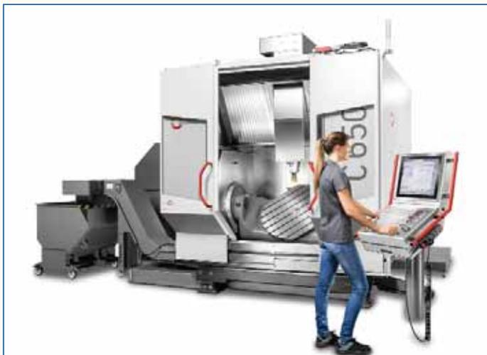
Обработка центр С 650 с наклонно-поворотным столом с ЧПУ
