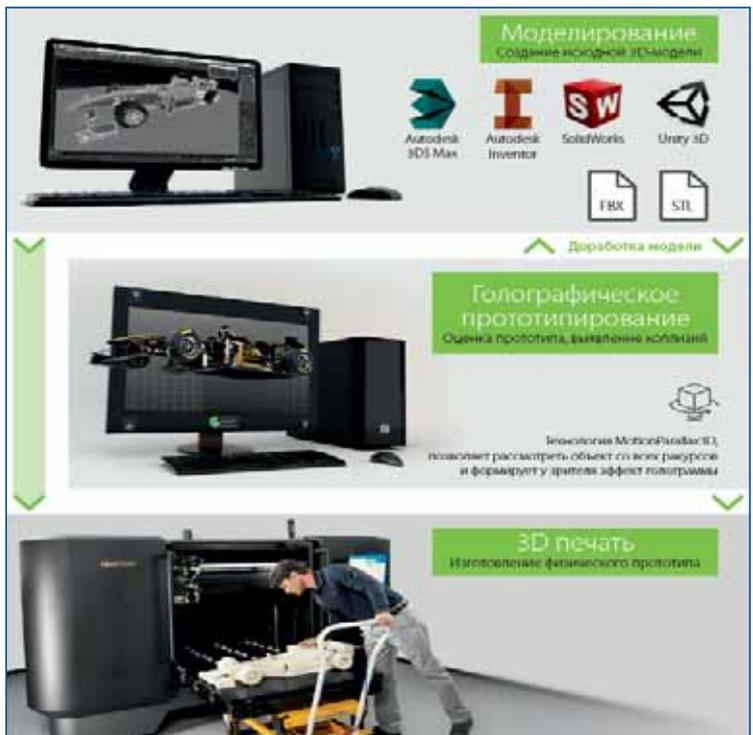
**Рис. 1** Технологическая цепочка процесса моделирования и прототипирования
