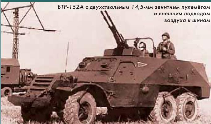
**БТР-152А** с двухствольным 14,5-мм зенитным пулемётом и внешним подводом воздуха к шинам
