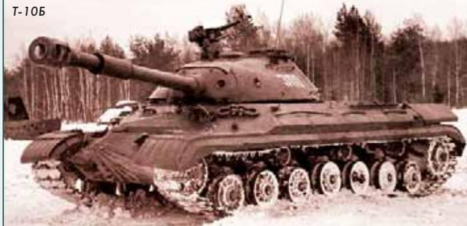
Следующая модификация танка Т-10 разрабатывалась в соответствии с решением пленума Научно-технического комитета ГБТУ, состоявшегося 14 декабря 1954 г. Модернизация коснулась в первую очередь вооружения танка. 122-мм орудие Д-25Т, которое устанавливалось ещё на танках ИС-2, было, наконец, отправлено на покой. Вместо него танк получил существенно более мощное орудие М-62Т2С (2А17), хотя и того же калибра.
