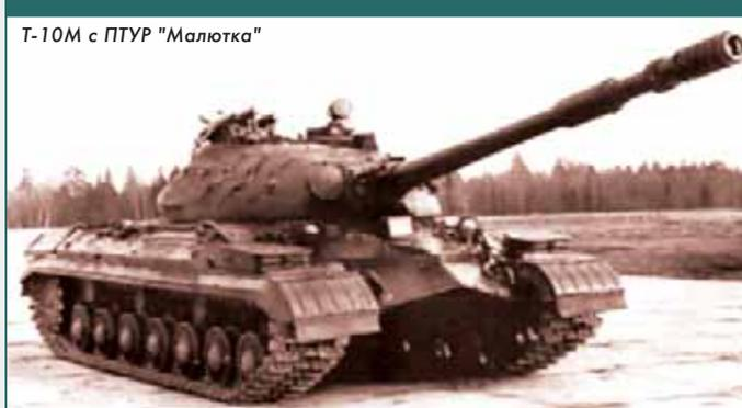
По результатам испытаний рекомендовалось выпустить опытную партию танков для войсковых испытаний, но в конечном итоге и от её установки отказались из-за невозможности обеспечения стрельбы с хода и защиты пусковой установки от огня стрелкового оружия. К тому же появились опытные образцы новых ракетных танков, создававшихся в ОКБТ ЛКЗ на базе среднего танка "Объект 432".
