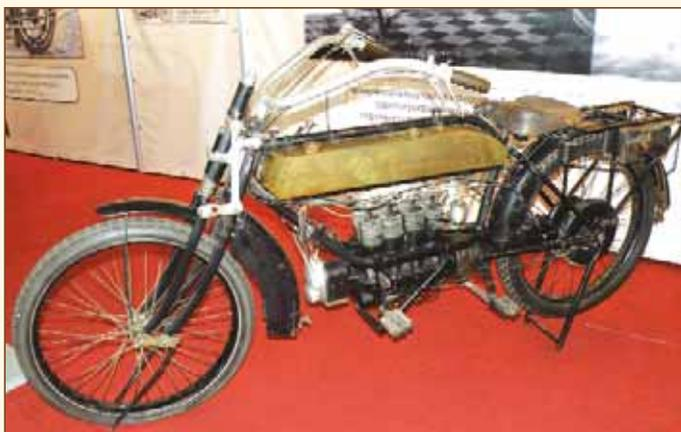
На выставке представлен мотоцикл 1913 года с мотором объемом 500 см<sup>3</sup> и мощностью 6 л.с., оснащенный двухскоростной коробкой передач и приводом на заднее колесо посредством вала.
