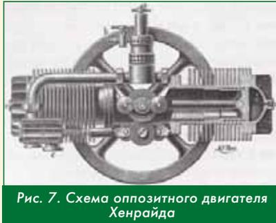
Рис. 7. Схема оппозитного двигателя Хенрайда
