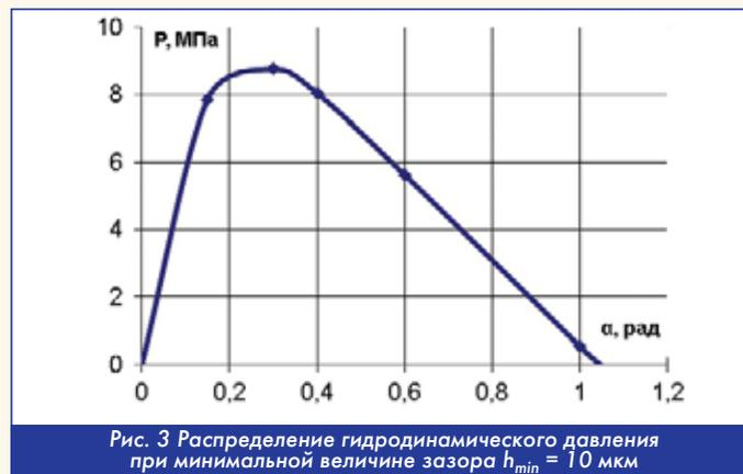
Рис. 3 Распределение гидродинамического давления при минимальной величине зазора  $h_{\min} = 10$  мкм
