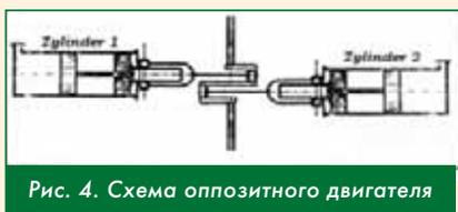
Рис. 4. Схема оппозитного двигателя
