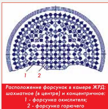
Расположение форсунок в камере ЖРД: шахматное (в центре) и концентрическое: 1 - форсунка окислителя; 2 - форсунка горючего
