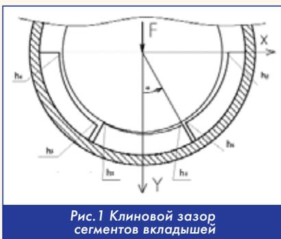
Рис. 1 Клиновой зазор сегментов вкладышей
