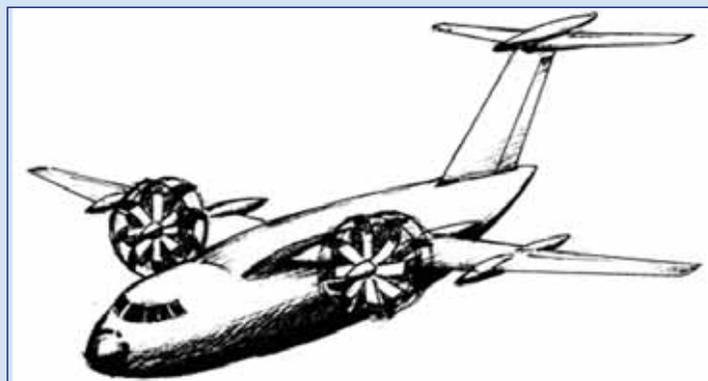
**Рис. 5 СТС с винтовентиляторами**
