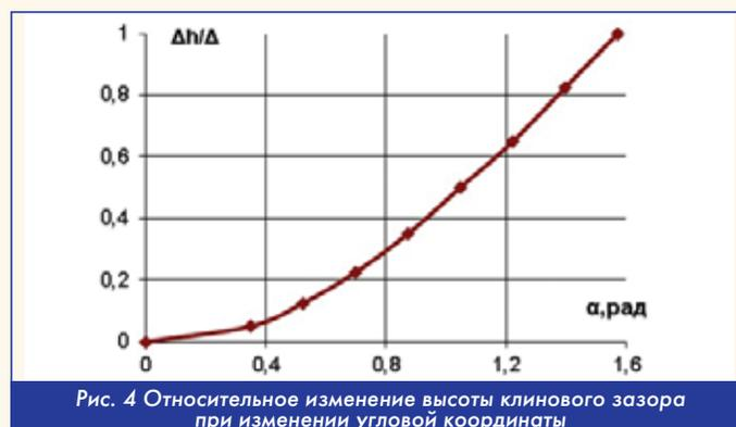
Рис. 4 Относительное изменение высоты клинового зазора при изменении угловой координаты
