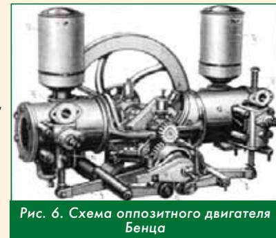
Рис. 6. Схема оппозитного двигателя Бенца
