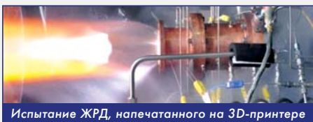
Испытание ЖРД, напечатанного на 3D-принтере
