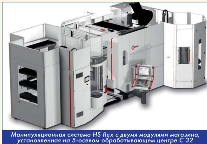
Манипуляционная система HS flex с двумя модулями магазина, установленная на 5-осевом обрабатывающем центре С 32
