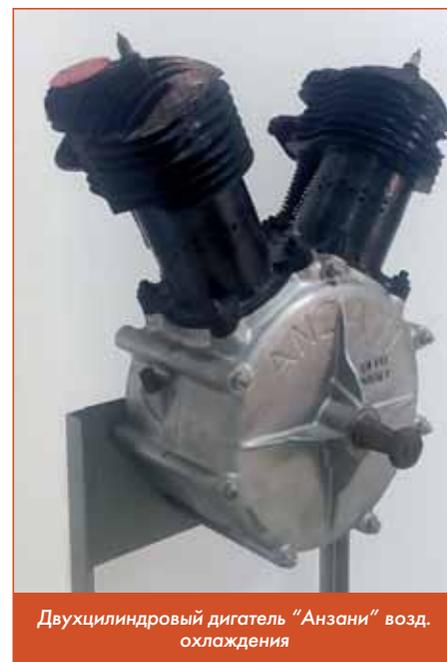
Двухцилиндровый двигатель "Анзани" воздушного охлаждения
