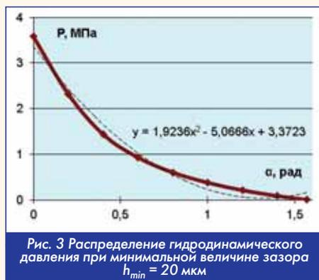
Рис. 3 Распределение гидродинамического давления при минимальной величине зазора  $h_{\min} = 20$  мкм
