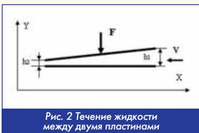
Рис. 2 Течение жидкости между двумя пластинами
