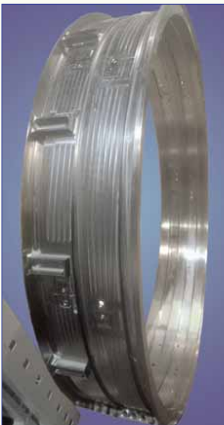
Внутренний корпус КВД из нового титанового интерметаллидного сплава
