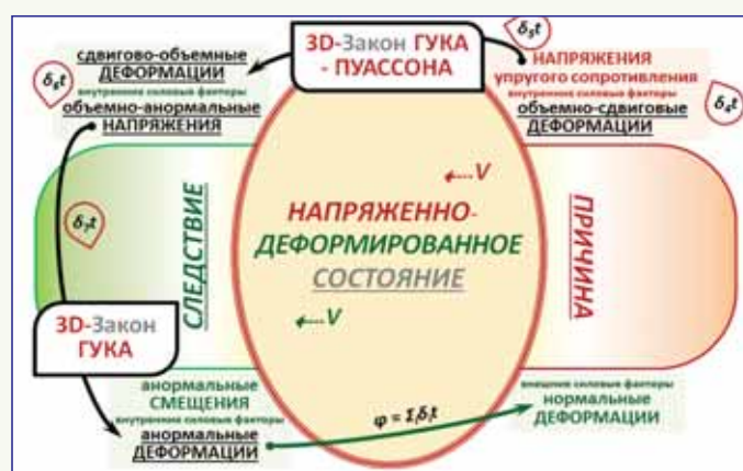
Рис. 2 Причинно-следственная модель упругого объемного (тензорного) сопротивления материала
