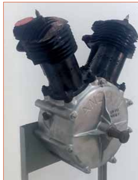
Двухцилиндровый двигатель "Анзани" воздушного охлаждения
