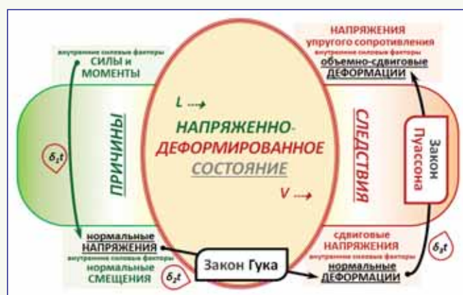
Рис. 1 Причинно-следственная модель возникновения линейных упругих состояний
