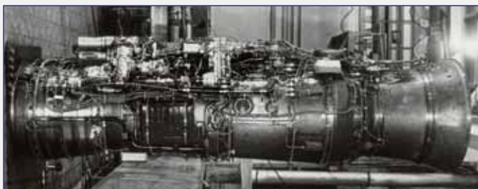
Двигатель Д-30Ф6 на испытательном стенде
