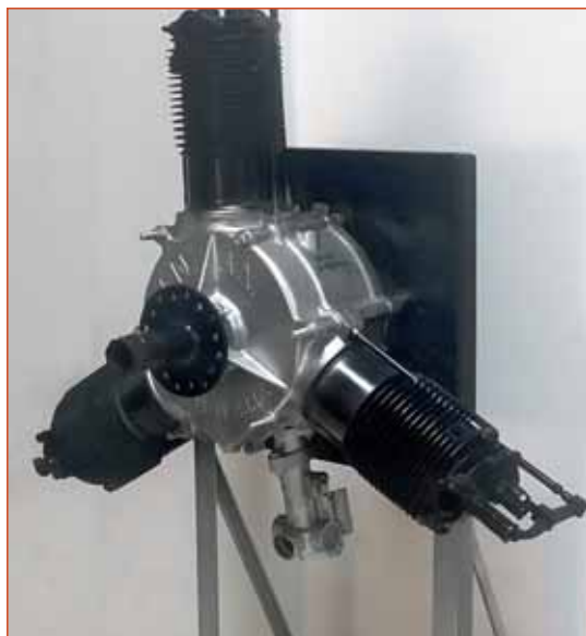
Трёхцилиндровый дигатель "Анзани". Цилиндры под 120°
