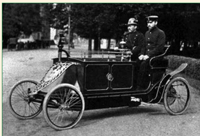
Автомобиль Луцкого для перевозки почты, представленный на выставке в Берлине в 1899 году, выпускавшийся фирмой Gesellschaft fur Automobilwagenbau
