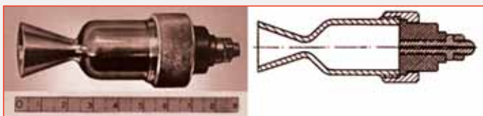
Электротермический реактивный двигатель В.П. Глушко
