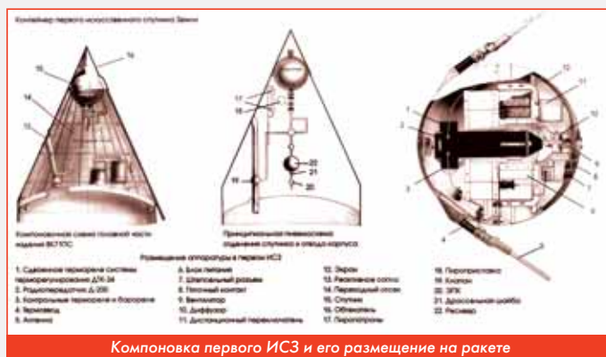
Компоновка первого ИСЗ и его размещение на ракете
