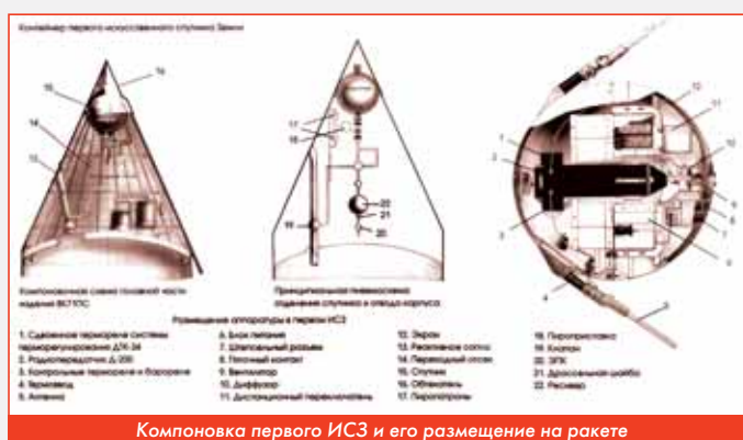
Компоновка первого ИСЗ и его размещение на ракете
