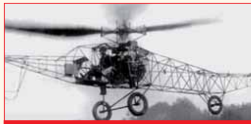
Рекордный (подъём до 605 м) лёгкий однороторный вертолёт А.М. Черёмухина 1932 года
