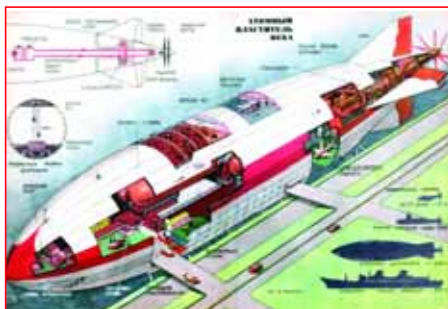
Проект дирижабля с атомной силовой установкой и распределёнными тяговыми двигателями (по журналу "Техника-молодёжи" конца XX века)
