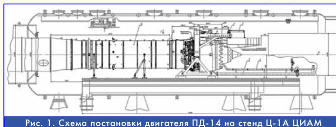
Рис. 1. Схема постановки двигателя ПД-14 на стенд Ц-1А ЦИАМ
