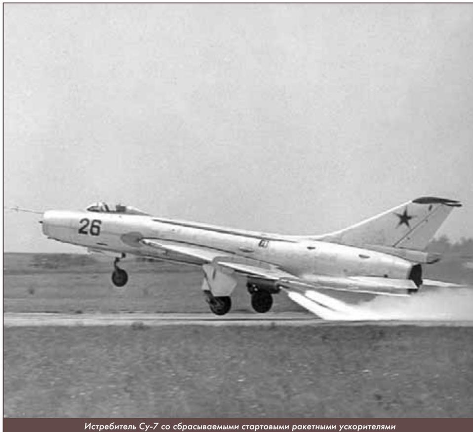
Истребитель Су-7 со сбрасываемыми стартовыми ракетными ускорителями
