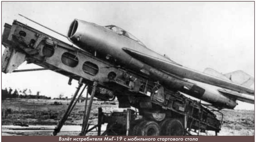
Взлёт истребителя МиГ-19 с мобильного стартового стола
