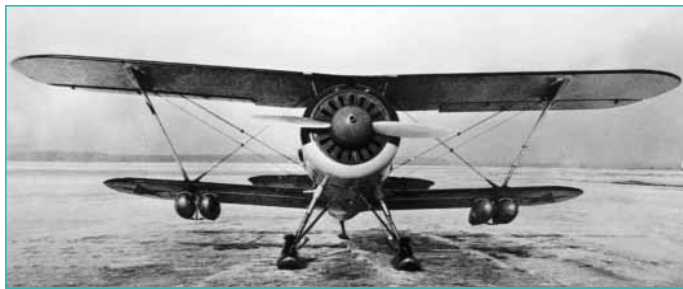
Истребитель И-15 бис с подвесными топливными баками конструкции Запанованного, 1939 г.
