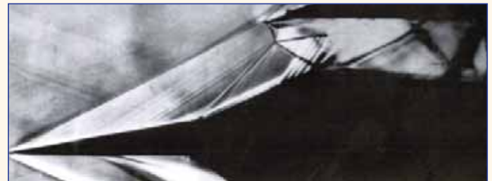
Рис. 4 Маховская интерференция догоняющих скачков [13]
