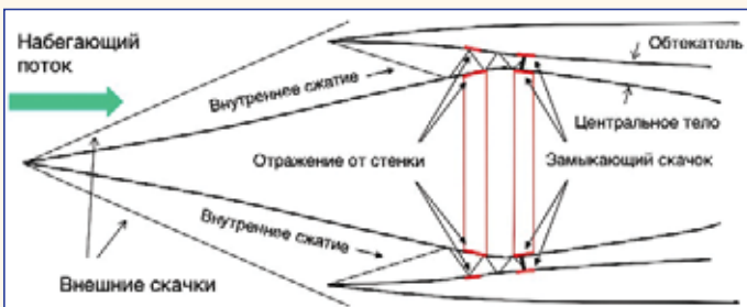
Рис. 1б Схема сжатия потока и ударно-волновой структуры в воздухозаборнике смешанного сжатия
