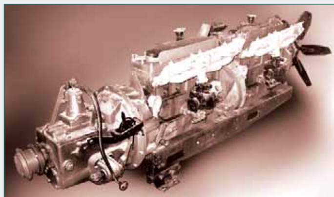
Силовой агрегат из двух последовательно соединённых рядных четырёхтактных шестицилиндровых карбюраторных двигателей
