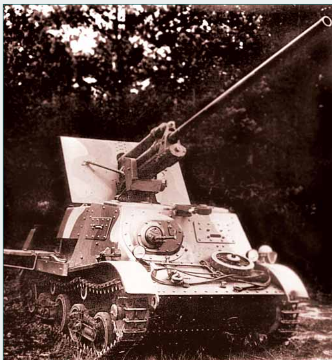
Первая попытка создания самоходного орудия калибра 57 мм для огневого сопровождения пехоты и борьбы с танками противника была предпринята в конце июля 1941 года, когда на войсковые испытания поступила самоходная 57-мм противотанковая пушка ЗИС-30, смонтированная на шасси легкого гусеничного тягача "Комсомолец". Из-за высокого расположения линии огня при короткой базе машины самоходка оказалась неустойчивой, стрельба из нее - неточной, а подвижность из-за возросшей массы (4,5 т) стала низкой, хотя несколько десятков таких орудий (из выпущенной сотни) и участвовали в обороне Москвы
