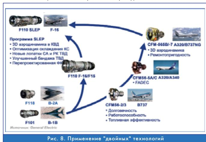
назначения F110 компании General Electric, то для этого в рамках программы SLEP (Service Extended Life Program) были использованы технологии и технические решения, разработанные для двигателей семейства CFM56. (рис. 8) [14]. И таких примеров, когда технологии, разработанные для двигателей гражданского назначения, применяются в двигателях военного назначения и наоборот, можно привести много.
