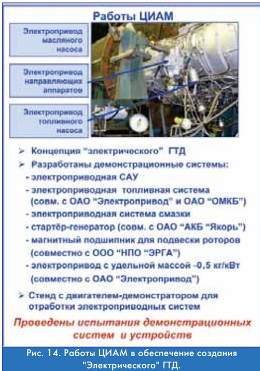
Рис. 14. Работы ЦИАМ в обеспечении создания "Электрического" ГТД.
