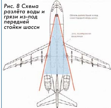
**Рис. 8** Схема разлёта воды и грязи из-под передней стойки шасси
