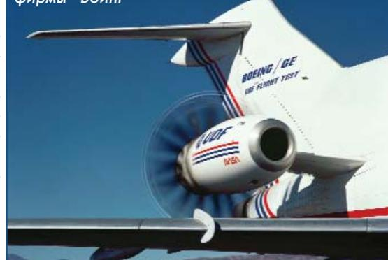
**Рис. 5** Экспериментальная силовая установка фирмы "Боинг" с UDF
