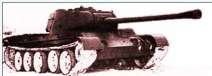
Танк Т-44 с 122-мм пушкой Д-25Т-44 (опытный образец № 3)
