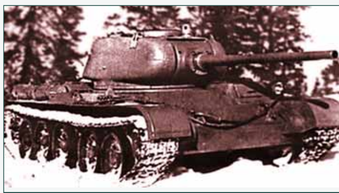
Танк Т-44 с 85-мм пушкой Д-5Т (опытный образец № 2)
