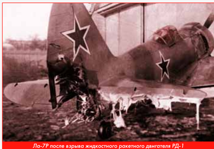
Ла-7Р после взрыва жидкостного ракетного двигателя РД-1
