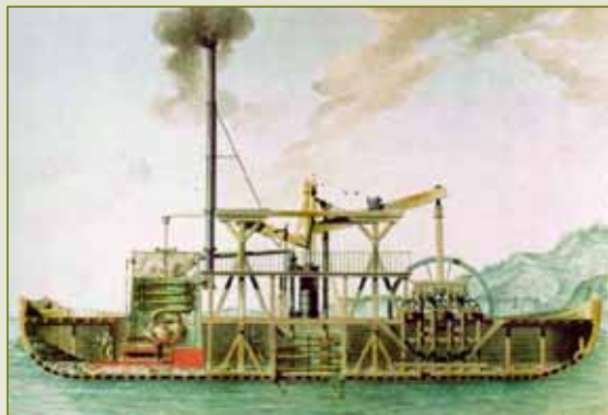
Устройство паровой землечерпалки Бетанкура...
