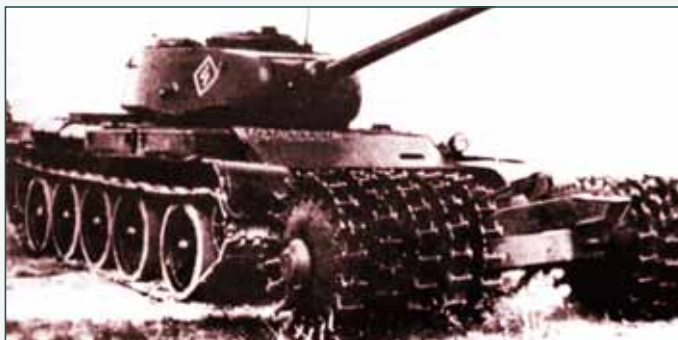
Танк-тральщик на базе Т-44Б валовой серии с тралом ПТ-М
