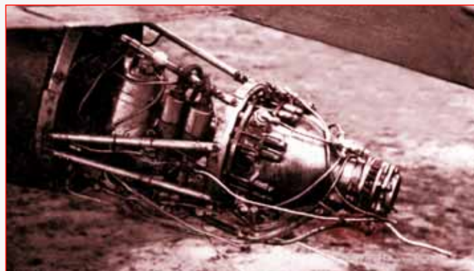
Жидкостный ракетный двигатель РД-1ХЗ на самолете Ла-7Р
