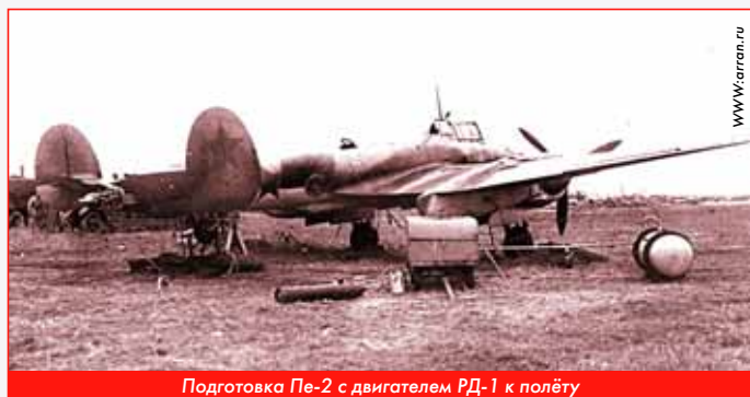
Подготовка Пе-2 с двигателем РД-1 к полёту
